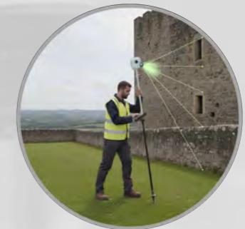
Midiendo desde un rango de 15 metros, mientras que la precisión se mantiene en 5 cm. Este método de recopilación de datos es una solución ideal para muchos entornos complejos, por ejemplo, áreas de difícil acceso y zonas peligrosas.
